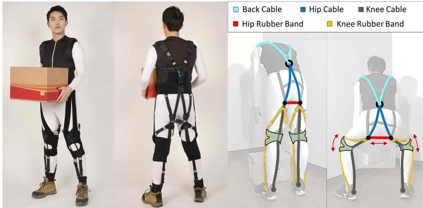
본 연구진이 개발한 신체구동식 가변임피던스(Body-powered variable impedance) 기술이 적용된 엑소 슈트이다. 원단, 케이블, 고무밴드 등의 유연한 재료로 구성되어 있고 별도의 동력원은 필요로 되지 않는다. 착용자가 스톱 동작을 취하거나 스쿼트 동작을 취할 때 케이블 들과 고무밴드의 각도가 달라지는 원리를 이용하여 임피던스(신축성)의 변화를 만들어 낸다.
